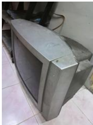
Televisyen jenis awal, yang menggunakan bim elektron dalam tiub katod yang mengimbas skrin pendafluor dengan pelbagai keamatan, untuk memberikan imej yang berubah-ubah.
