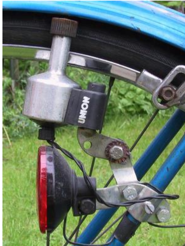
Pergerakan magnet dalam dynamo menghasilkan aliran elektrik.
